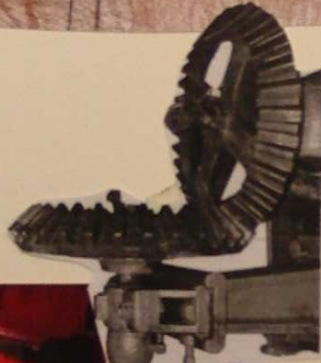
Alla fine delle scale, c'è una ingranaggia che serve a sbar- rare l'acqua.
